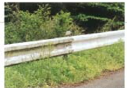
▲ガードレールにおけるテスト施工。右側のエヌティオの塗装面には藻の発生がみられません。
